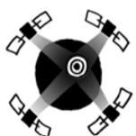
GPS est l'abréviation de *Global Positioning System* (système de positionnement mondial). Ce système est composé d'un ensemble de satellites américains qui émettent continuellement des signaux de positionnement en tout point de la Terre. Ces signaux, reçus par votre GPS portable ViaMichelin Navigation, vous permettront de connaître votre position et de vous diriger vers votre destination.
