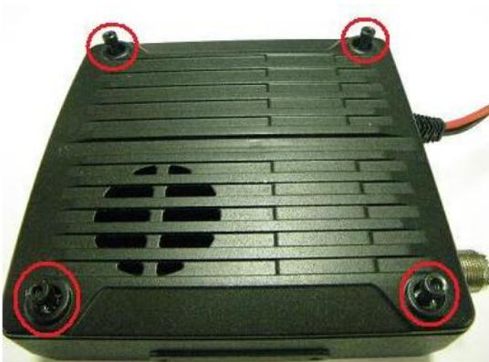
Serrez les quatre vis. (Une clé hexagonale de 3.0mm est requise pour cette étape)
