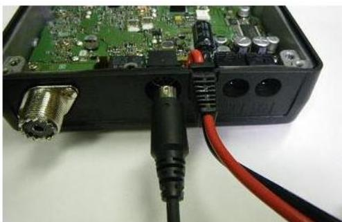
Débrancher le câble de programmation de la prise 'DATA' du FTM-350.
