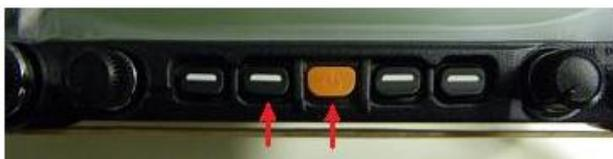
Mettre le FTM-350 sous tension : appuyez et maintenez la touche située sur la gauche du commutateur [POWER] tout en mettant la radio sous tension. Ceci vous donnera accès au mode 'fonction spéciale'.
