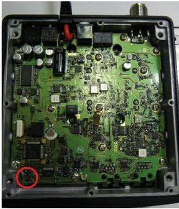
Localiser le commutateur de programmation, à l'avant de l'appareil, côté gauche. (Voir photo à gauche)
