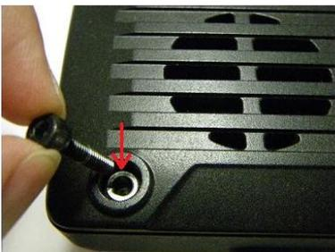
Insérez une vis, ainsi qu'une rondelle à ressort dans chacun des quatre trous du capot supérieur.
