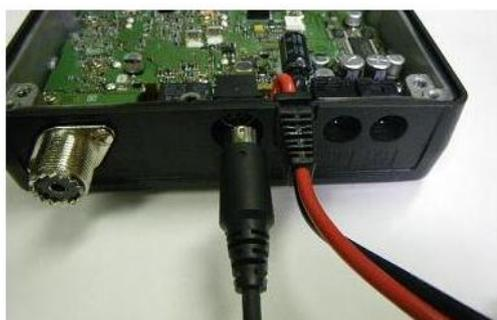
Brancher le câble de programmation CT-140 ou CT-142 à la prise 'DATA' (connecteur Mini-DIN) localisé sur le panneau arrière du FTM-350.
