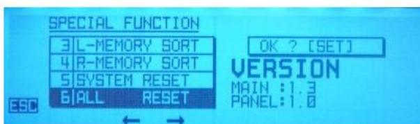
En utilisant la commande [DIAL] de gauche (rotation), sélectionnez le menu 6 [ALL RESET], et appuyez sur le [DIAL] de gauche deux fois pour sélectionner et accepter l'option 6, qui vous donnera une réinitialisation totale de la radio.
