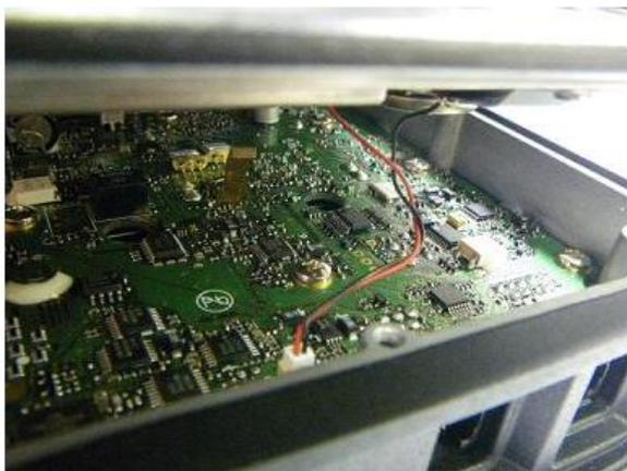
Soulever soigneusement le capot supérieur afin d'accéder au commutateur de programmation.
